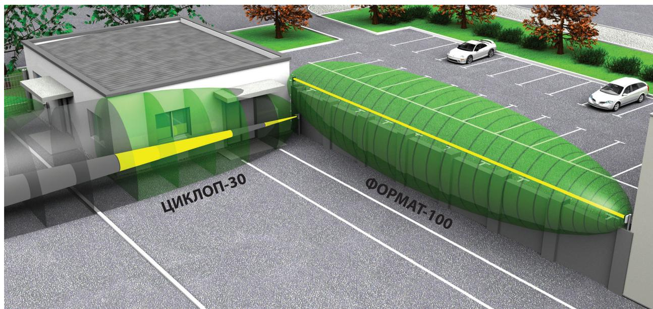
Охрана периметра с помощью комбинированного двухпозиционного извещателя ФОРМАТ-100 и комбинированного однопозиционного извещателя ЦИКЛОП-30.
