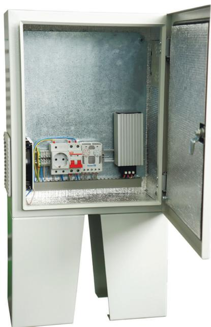
Поддержание внутренней температуры в заданном диапазоне достигается посредством систем обогрева и вентиляции, теплоизоляции корпуса и вводом кабеля через гермовводы. Регулятор температуры позволяет плавно регулировать температуру включения и выключения обогревателя и вентилятора.
